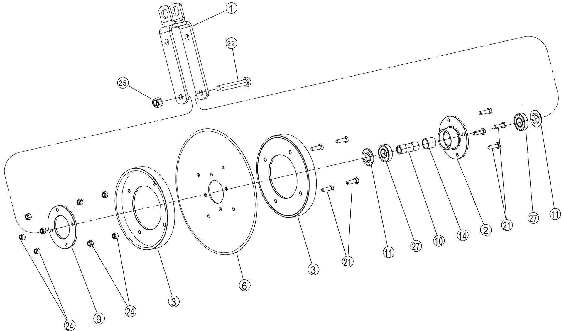
Схема установки окучника на секцию
